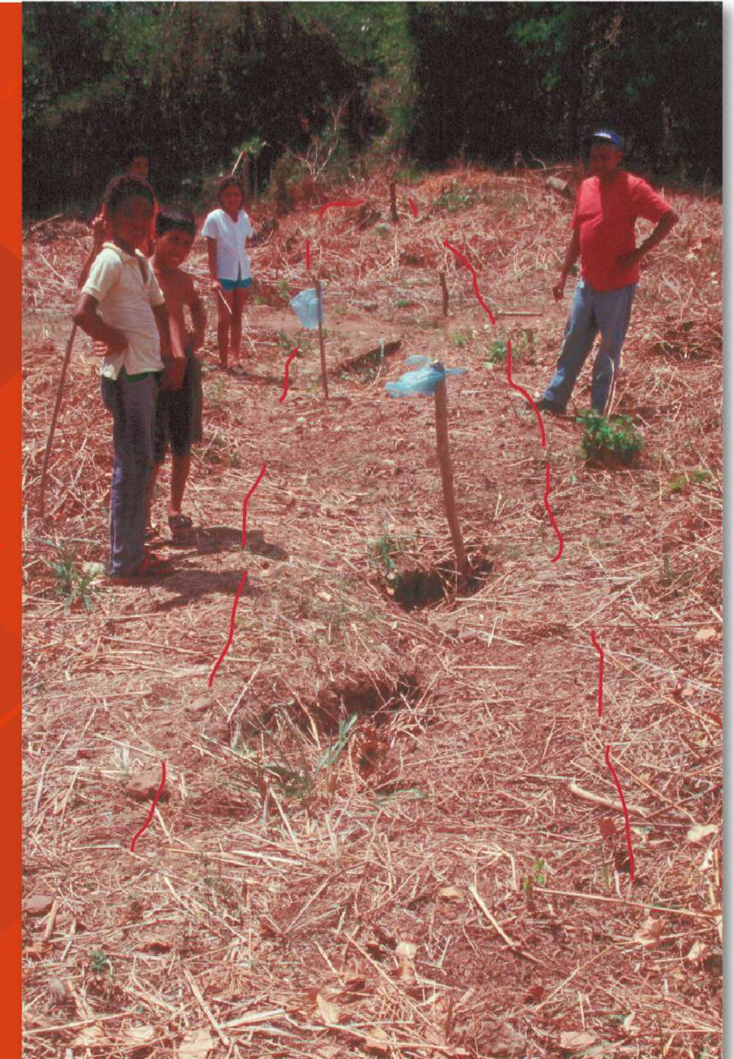
Vista longitudinal de la trinchera a través de la ruptura del sismo de Cariaco (ver foto anterior), estando la falla en el salto de la topografía (indicado por flechas) y en el cambio de material grueso a fino. Fuente: Franck A. Audemard (1997).
