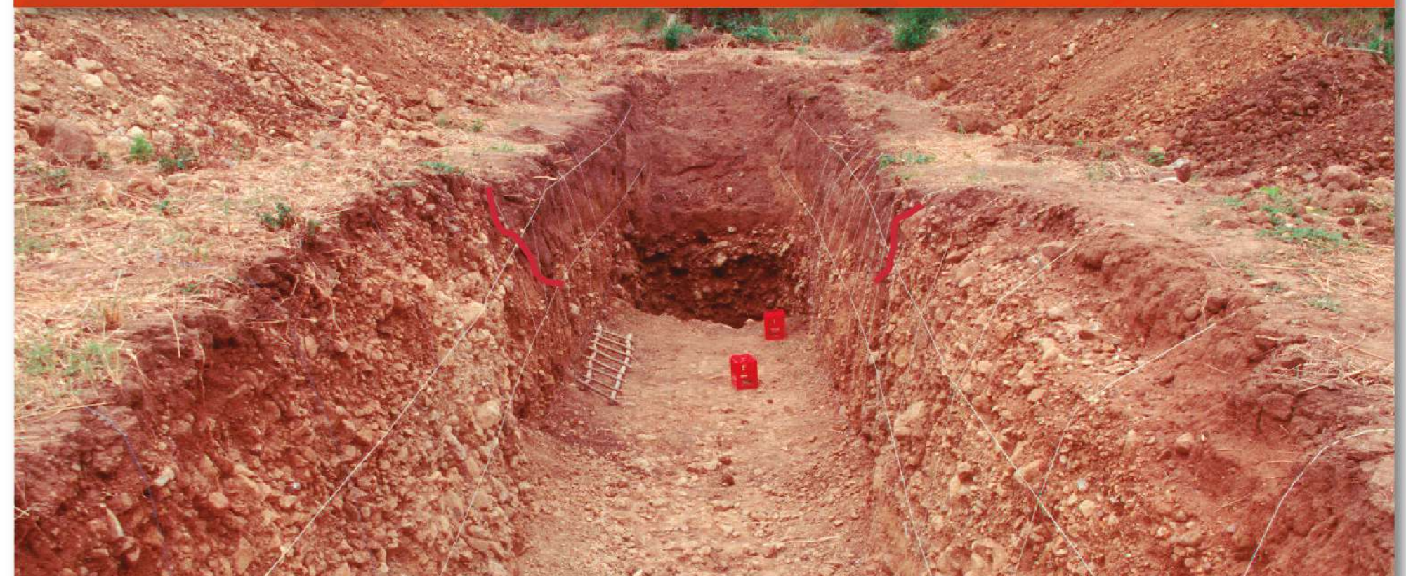
Vista longitudinal de la trinchera a través de la ruptura del sismo de Cariaco (ver foto anterior), estando la falla en el salto de la topografía (indicado por flechas) y en el cambio de material grueso a fino. Fuente: Franck A. Audemard (1997).
