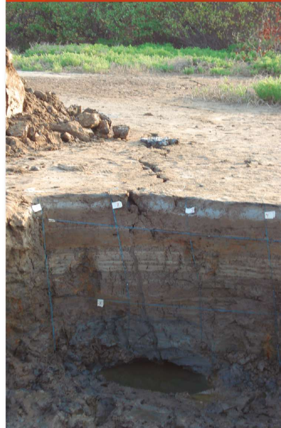
Detalle en pared de calicata, evidenciando la zona licuada de la grieta abierta por relajamiento lateral (ver foto anterior) en el sismo de Morón del 12 de septiembre 2009. Fuente: Luz M. Rodríguez (2009).
